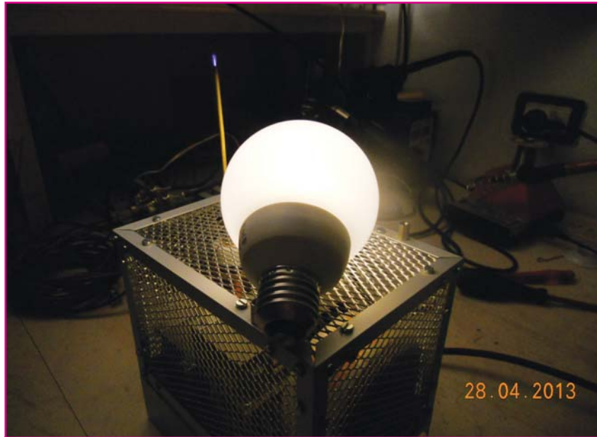
Figura 01: a causa dell'intenso campo elettrico un tubo al neon si illumina perfettamente semplicemente avvicinandolo all'elettrodo
