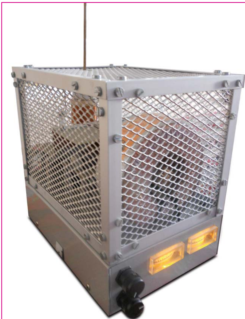
Figura 04: Il prototipo del tweeter a corona: dalla gabbia di schermo esce solo l'elettrodo scintillatore. I due strumenti sul frontale indicano la tensione di “bias” del driver a RF e il livello di modulazione
