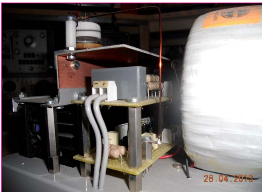
Figura 06: All'interno della gabbia di schermo è collocato il driver a RF suddiviso in due schede: quella superiore contiene le resistenze di carico di drain e i condensatori di filtro dell'alimentazione HV. Sulla scheda inferiore è realizzato il driver del mosfet: si noti il filo rigido di rame che proviene dal distanziale in teflon nei pressi della bobina e si collega alla scheda driver. Tale filo costituisce l'antenna che preleva il campo irradiato e consente l'aggancio della frequenza di risonanza
