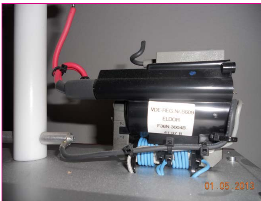
Figura 20: particolare del trasformatore ELDOR FN36N.3004B. Si noti il primario composto da 5+5 spire di filo da 0.5mm quadri avvolto direttamente sulla colonna del nucleo.
