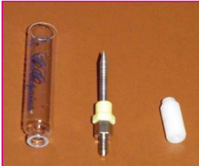
Figura 16: componenti di uno ionophone casalingo (una provetta di un campione di profumo, un chiodo appuntito incastrato in un distanziale esagonale di ottone, un distanziale di teflon).
