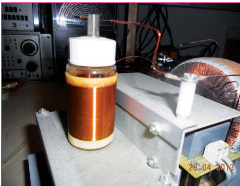
Figura 07: Particolare della bobina di Tesla e del filo rigido usato come antenna
