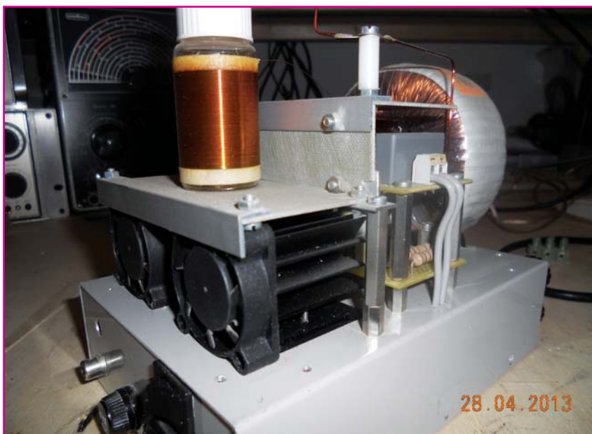
Figura 05: Particolare del dissipatore utilizzato per i mosfet del driver RF e del modulatore e dei due piccoli ventilatori utilizzati per garantire un minimo di circolazione d'aria.
