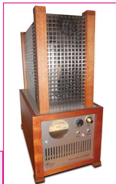
Figura 24: il mio tweeter ad arco in versione definitiva, con il mobiletto in legno e la gabbia di protezione della scarica.
